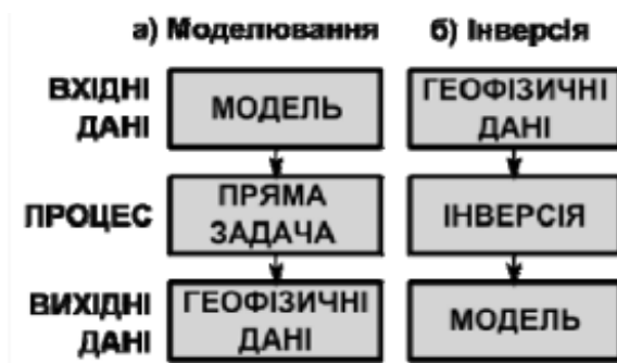
Рисунок 1.3.4 Принципова різниця між розв'язанням прямої та оберненої задачі (за Тройніч К. та Вижва С., 2014)
